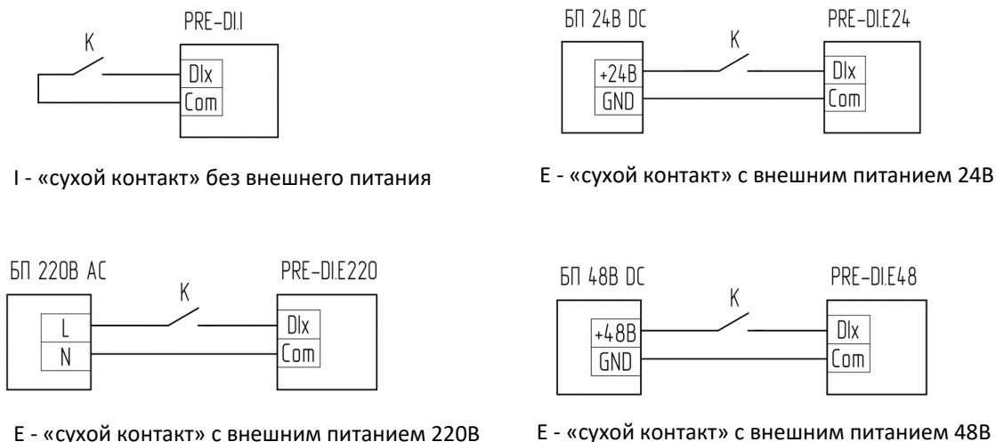
Рис. П1.2. Схемы вариантов исполнения дискретных входов модулей дискретного ввода
